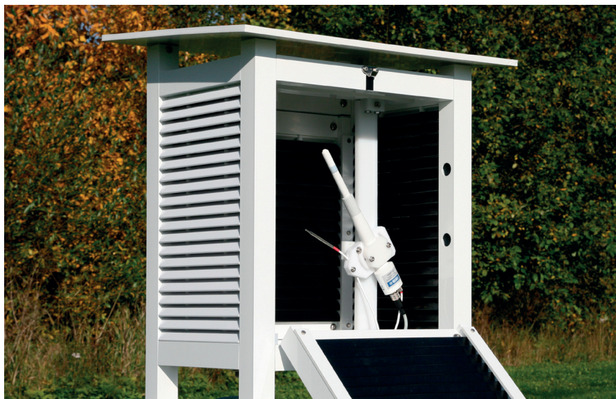
HMP155 com um novo e estável sensor 180R HUMICAP® e uma sonda de temperatura adicional
