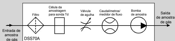
O sistema de amostragem DSS70A inclui um filtro para a limpeza das impurezas da amostra de gás e uma válvula de agulha para o controle da amostra com um medidor de fluxo. Uma bomba de amostra é utilizada para gerar um fluxo de amostra em processos de pressão ambiente.
