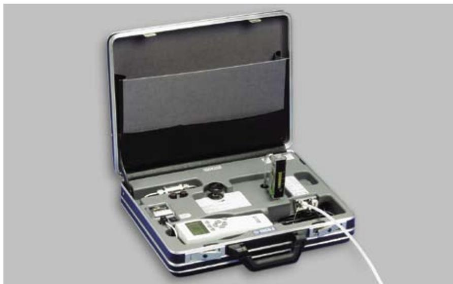
*O DSS70A proporciona uma solução compacta para a verificação do ponto de orvalho em campo onde a medição direta é difícil. Tratamento de metal e processo de secagem de plástico, são aplicações típicas para o sistema de amostragem*
